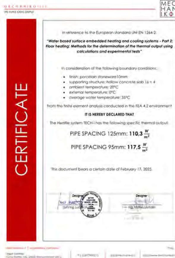
Img 6 – certificazione UNI EN 1264-2 HEATILE TECH
